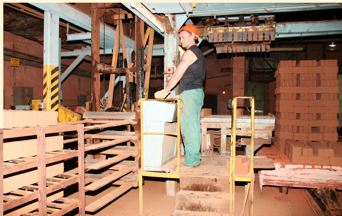
Перегрузочное отделение. Здесь выполнялась ручная перегрузка и укладка сырца бригадой из пяти человек с сушильных вагонеток на печные вагонетки. Теперь эту работу выполняют автоматы-садчики
